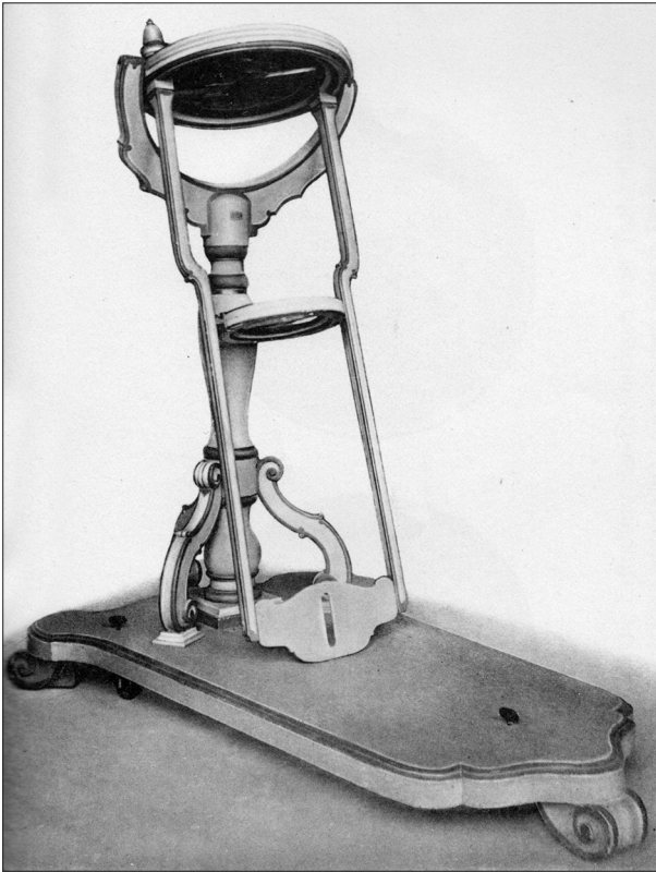
Größter Brennlinsenapparat von E. W. von Tschirnhaus (aus NLM 88 [1912], Tafel IV)
